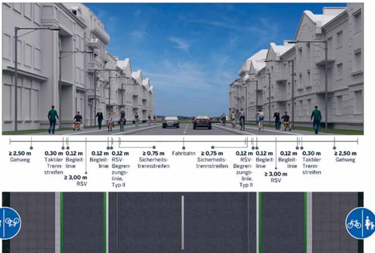
Abbildung 4: Straßenbegleitende RSV im Einrichtungsverkehr (Skizze)
