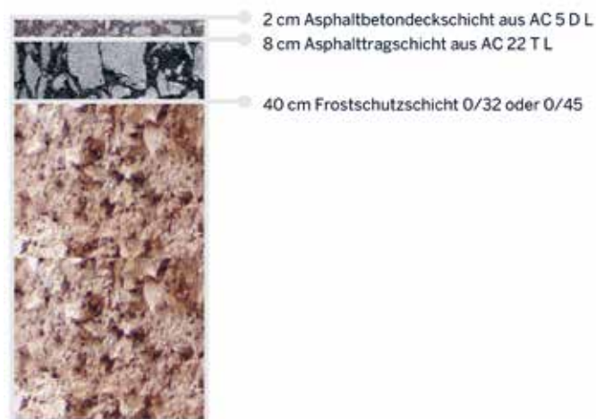
Abbildung 43: Belag und Deckenaufbau
