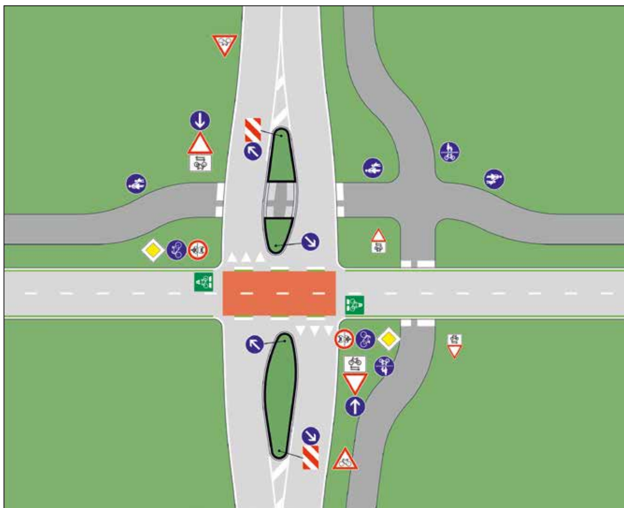
Abbildung 27: Bevorrechtigte RSV kreuzt eine untergeordnete Straße außerorts (siehe auch Anhang 11.1.15)
