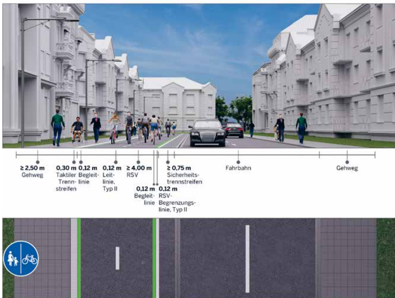
Abbildung 3: Straßenbegleitende RSV im Zweirichtungsverkehr (Skizze)
