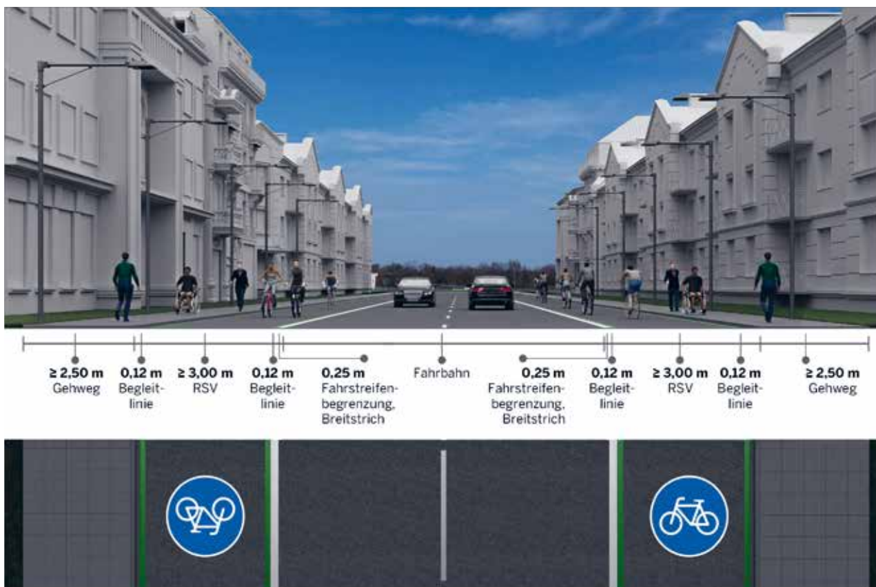
Abbildung 5: Straßenbegleitende RSV als Radfahrstreifen im Einrichtungsverkehr (Skizze)
