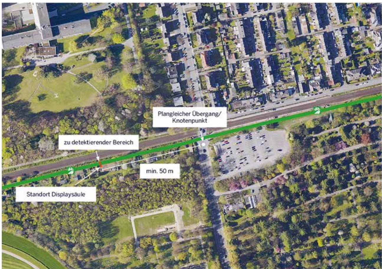
Erhebungsstandort im Bereich eines plangleichen Knotenpunktes (Bild: RVR, Bearbeitung Planerbüro Südstadt nach LS NRW)
