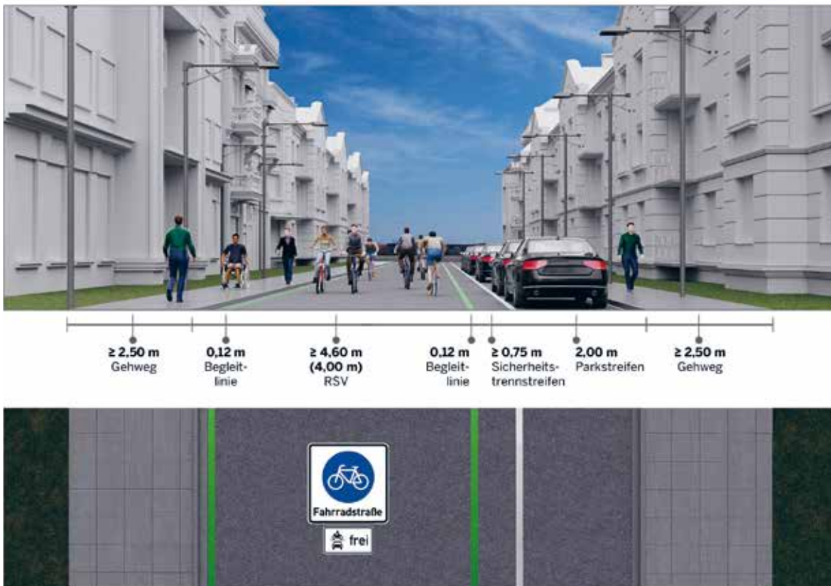
Abbildung 9: RSV als Fahrradstraße mit einseitigen Längsparkständen (Skizze)
